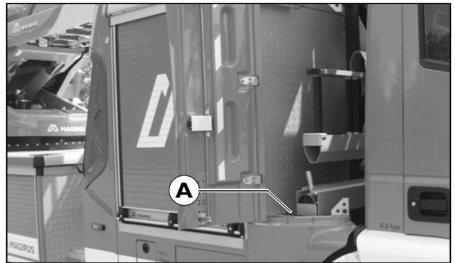
[391] Einbauort (A) der Sicherungsdosen für die Aufbaufunktionen
