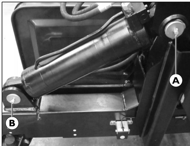
[426] Schmiernippel am Stützzylinder oben (A) und unten (B)
