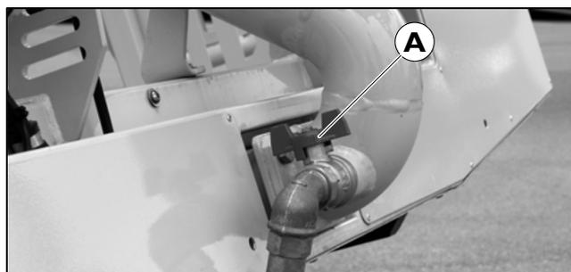
[374] Rettungskorb RC400: Absperrventil für Selbstschutzanlage, gleichzeitig Entwässerungsventil für Wasserführung im Korbboden
