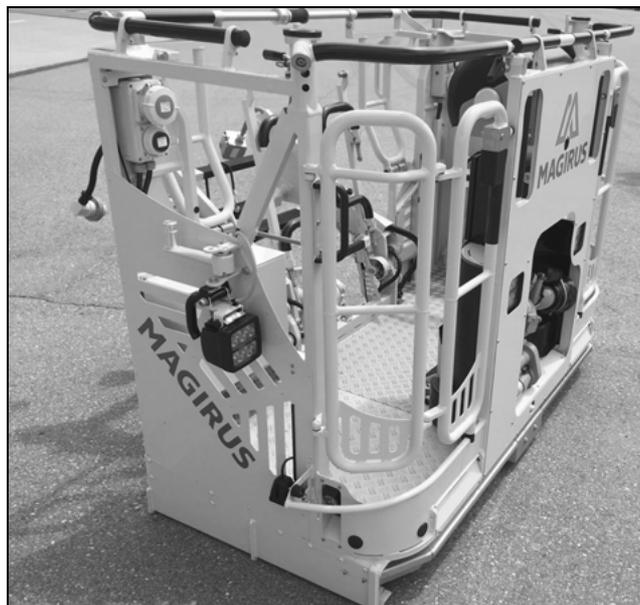
[334] Rettungskorb RC400 mit bündig schließender Übersteighilfe
