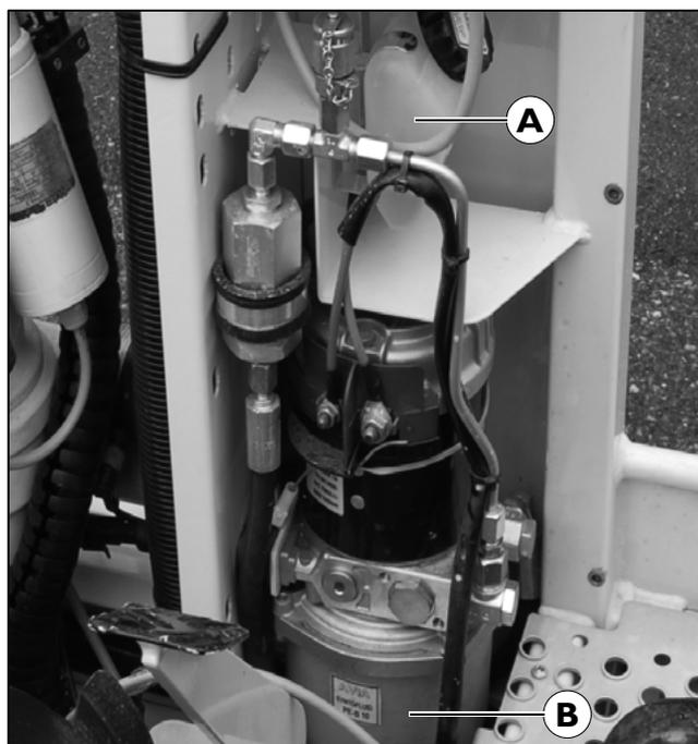
[439] Rettungskorb RC400/RC500: Ausgleichsbehälter (A), Hydraulikflüssigkeitsbehälter (B) mit Filter
