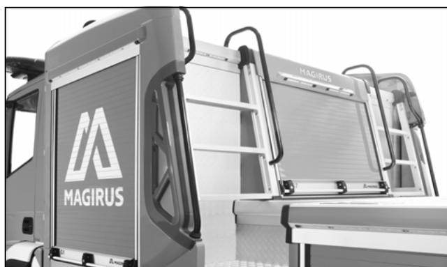
[16] Rollläden seitlich und optional an der Rückseite des hohen Podiumskasten
