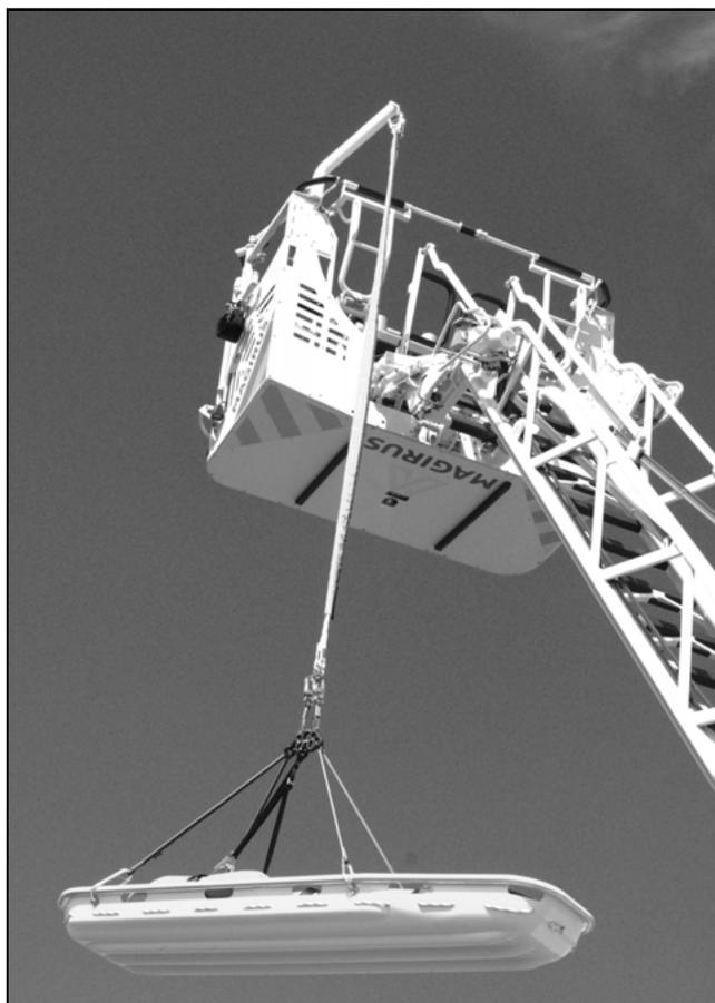
[10] Rettung mit Trage als Sonderfall der Absturzsicherung durch Halten (Darstellung mit SafetyPeak für Stülpkorb)
