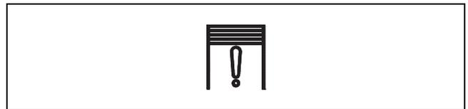
[51] Kontrolllampe *Geräteraum geöffnet* im Fahrerhaus
