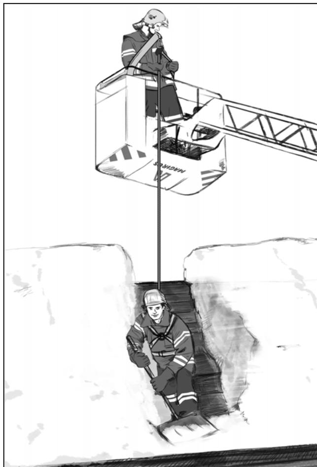
[331] Schneeräumen auf einem Flachdach (Darstellung mit Safety Peak für Stülpkorb)
