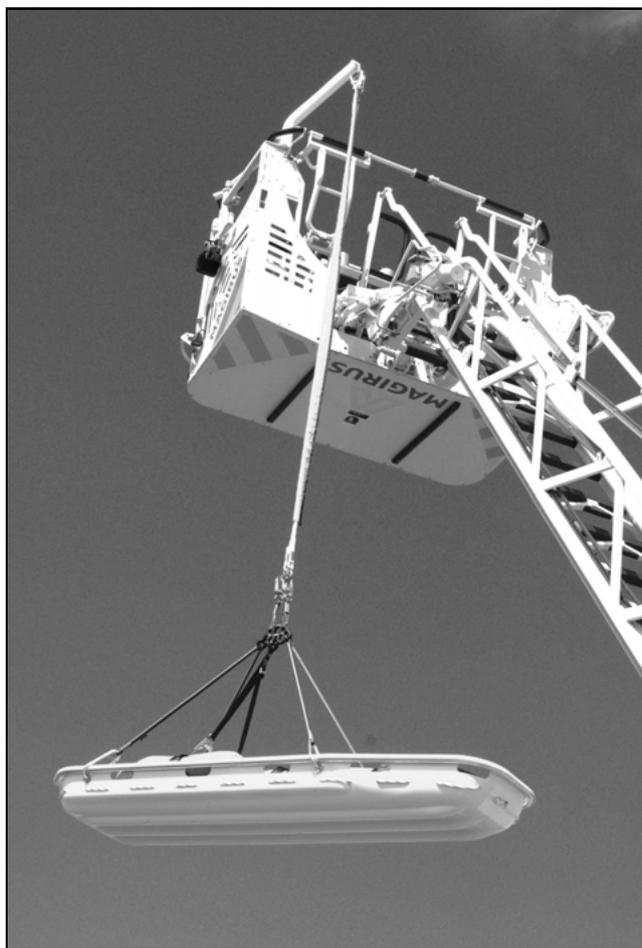
[330] Rettung mit Trage als Sonderfall der Absturzsicherung durch Halten (Darstellung mit SafetyPeak für Stülpkorb)
