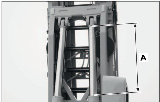
[433] Ausfahrlänge der Aufrichtzylinder
