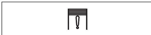
[18] Kontrolllampe *Geräteraum geöffnet* im Fahrerhaus
