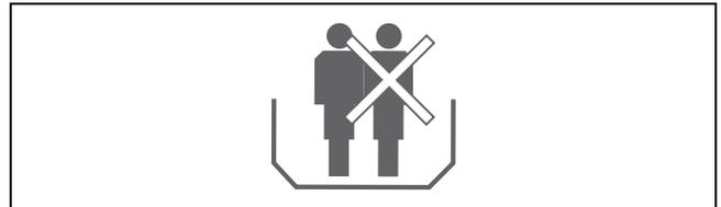
[286] Symbol *Eingeschränkter Korbbetrieb* auf dem linken Steuerhebel am Korb- oder Hauptbedienstand
