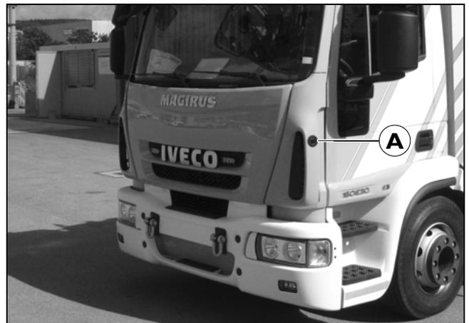
[217] Zustimmungstaster (A) an der Frontseite des Fahrerhauses
